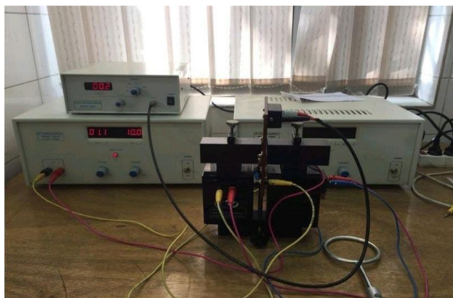
شکل ۶- نحوه قرار گرفتن برد هال در وسط سیم پیچ‌ها و وصل کردن سیم پیچ‌ها به منبع تغذیه در آزمایشگاه حضوری (سنتی)
