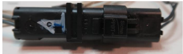
شکل ۸: کانکتور شماره ۱ پس از آزمون ارتعاشی
