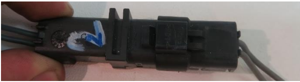
شکل ۹: کانکتور شماره ۲ پس از آزمون ارتعاشی
