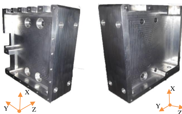
شکل ۴: نگهدارنده کانکتور طی آزمون ارتعاشی در سه راستای X، Y و Z
