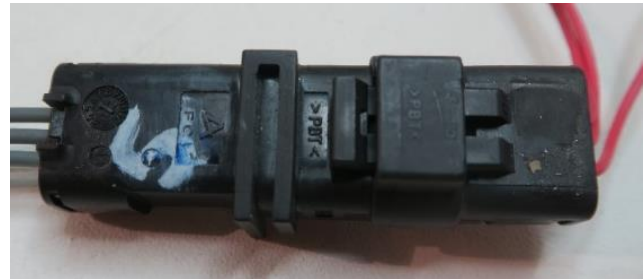
شکل ۱۵: کانکتور شماره ۵ پس از آزمون ارتعاشی
