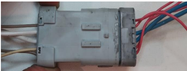
شکل ۱۶: کانکتور شماره ۶ پس از آزمون ارتعاشی
