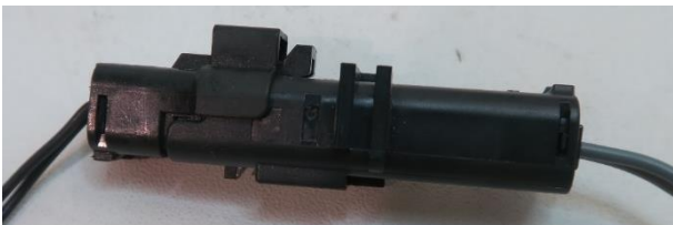
شکل ۱۱: کانکتور شماره ۴ پس از آزمون ارتعاشی
