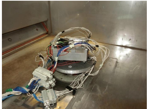
شکل ۷: اجرای آزمون ارتعاشی درون محفظه تنظیم دما (در راستا Z)
