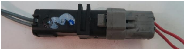
شکل ۱۰: کانکتور شماره ۳ پس از آزمون ارتعاشی
