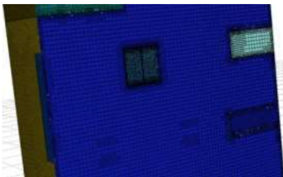
شکل ۷ تولید شبکه برای محفظه رایانه با گرماگیر مستقیم
