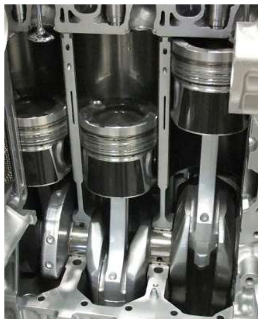
شکل ۲ محل قرار گیری شاتون [۲]
