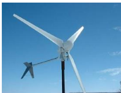
شکل ۵: توربین های بادی با محور چرخش افقی
