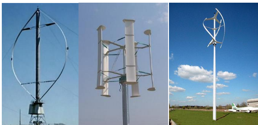
شکل ۴: توربین بادی با محور چرخش عمودی
