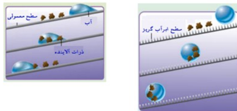
شکل 12: مقایسه سطح معمولی با سطح آبگریز [http://edu.nano.ir/paper/385]
